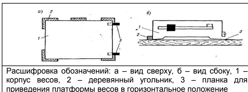
Рисунок 2 – Установка весов на дощатом основании будки
